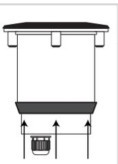
Установка уплотнителя на корпус
